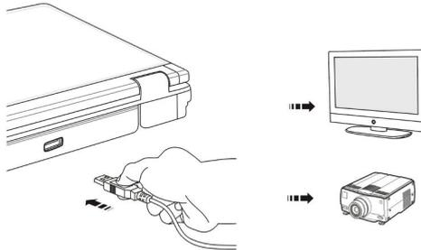
Zum Anschließen eines externen Anzeigerätes überzeugen Sie sich zunächst davon, dass sowohl Notebook als auch externes Anzeigerät ausgeschaltet sind, erst dann schließen Sie das Anzeigerät an Ihr Notebook an.
