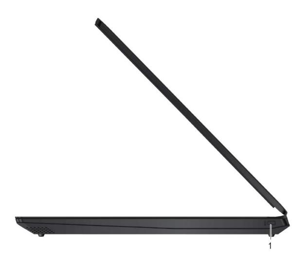
1. Schlitz für das Minisicherheitsschloss Sichern Sie den Computer mit einer kompatiblen Sicherheits-Kabelverriegelung an einem Tisch oder anderen Befestigungsmöglichkeiten.
