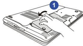
2. Drücken Sie den Akku herunter, um den Akku im Batteriebehälter zu befestigen.
