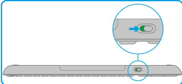
Hinweis: Vergewissern Sie sich, dass der Tastatur-Switch in der „ON“-Stellung steht. Der EIN-/AUSSCHALTER befindet sich auf der Tastatur oben.
