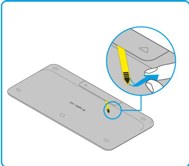
Schritt 2: Ziehen Sie den gelben Schutzstreifen der Batterie heraus.
